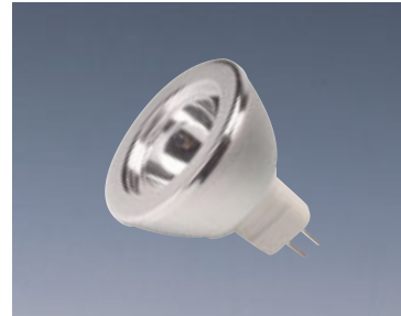
SL-203 (-E27-GU10) MR-16 AC/DC 12V 消耗功率:3.5W / LED 2.8W Color:W / WW / R / G / B / Y 角度:76° 流明:160lm (不定期提升)
