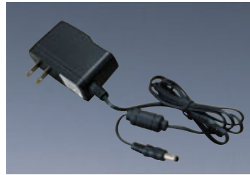
SP-1513 12W變壓器(插頭式) 輸入:AC:90~220V 輸出:DC:12V 1A 12W 安規:UL / CE / FCC / CNS / CB...
