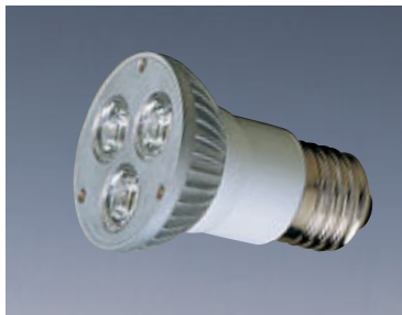
SL-208 E27 AC:90~220V 消耗功率:5.0W / LED 4.2W Color:W / WW / R / G / B / Y 角度:15° or 30° 流明:225lm or 350lm (不定期提升)
