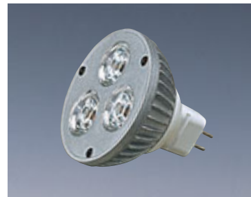
SL-209 MR-16 AC/DC 12V 消耗功率:5.0W / LED 4.2W Color:W / WW / R / G / B / Y 角度:15° or 30° 流明:225lm or 350lm (不定期提升)
